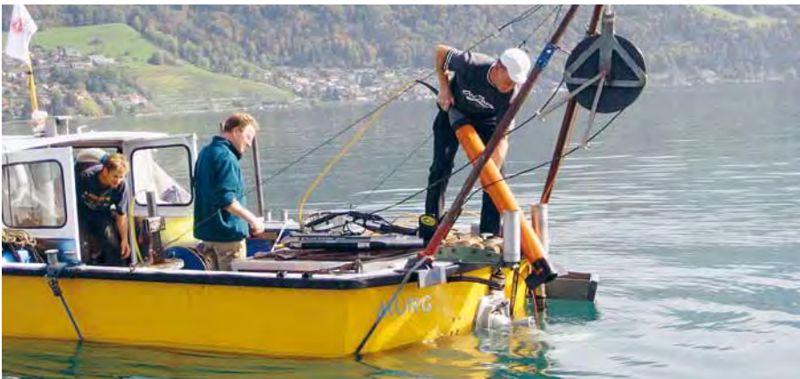
Oben: Einrichtung zum Heben von Munitions-Testobjekten Unten: Grossflächige Munitionsortung mit Magnetometer und Side-Scan-Sonar
